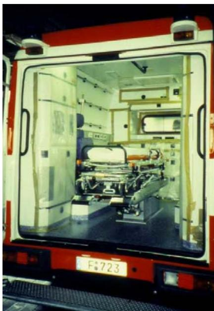
Rettungswagen mit wannenartig ausgegossenem Boden. Schwer zugängliche Flächen sind mit Folie zugedeckt und abgeklebt. Nicht benötigte Ausrüstung ist entfernt.
